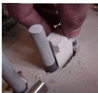
(6) 取出需要更换的硅钼棒 (7) 更换新棒时，氧化铝塞块与硅钼棒同时放入棒槽底部
